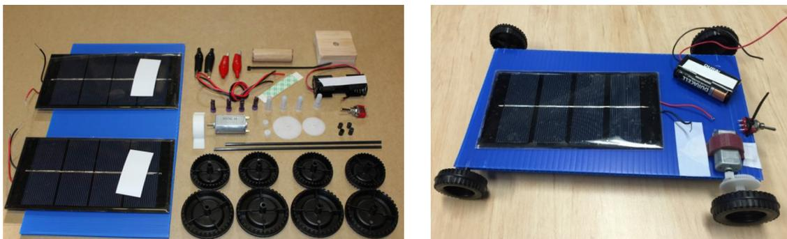
*Figure 1. Items within the mini electric-vehicle (EV) kit and an example mini EV*
